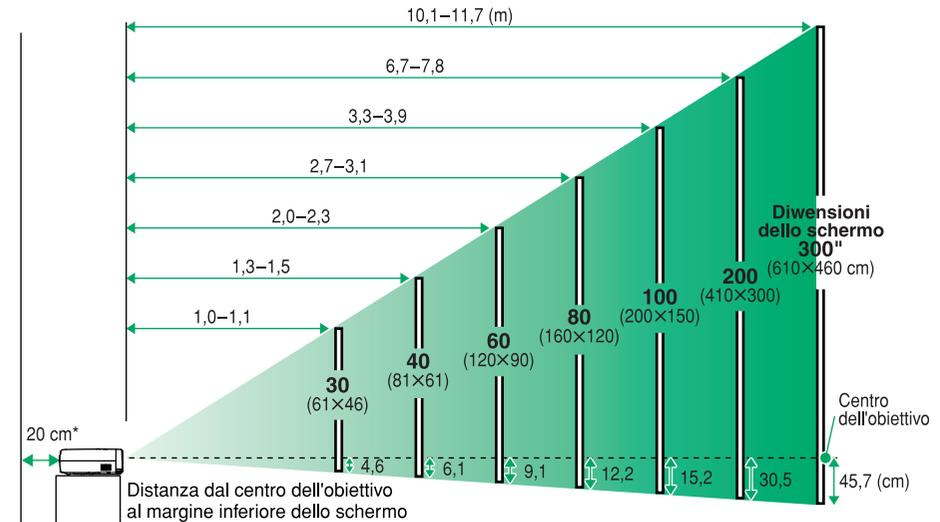
\* Con l'installazione a muro, lasciare uno spazio di circa 20 cm tra il proiettore e il muro.
