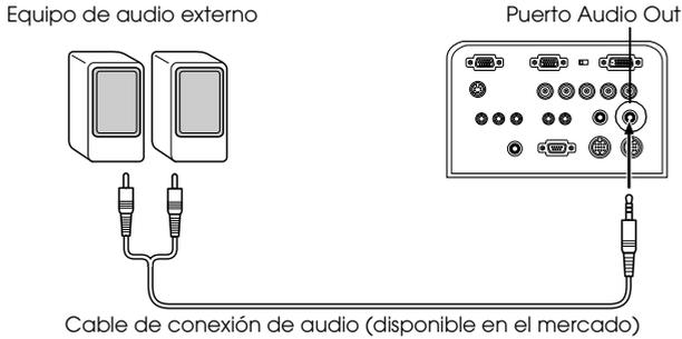
Utilice cables de conexión de audio disponibles en el mercado (conexión de clavija <--> 3.5 mm. estéreo conexión mini-jack).
