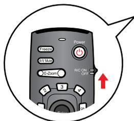
Se si utilizza il telecomando, posizionare il commutatore R/C in posizione ON e quindi premere il
