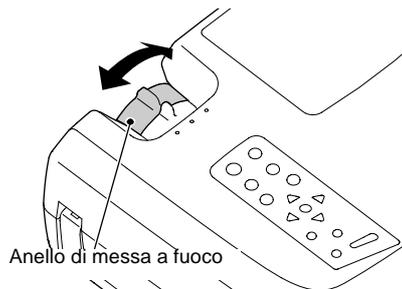
**Ruotare l'anello di messa a fuoco per regolare il fuoco dell'immagine.**
