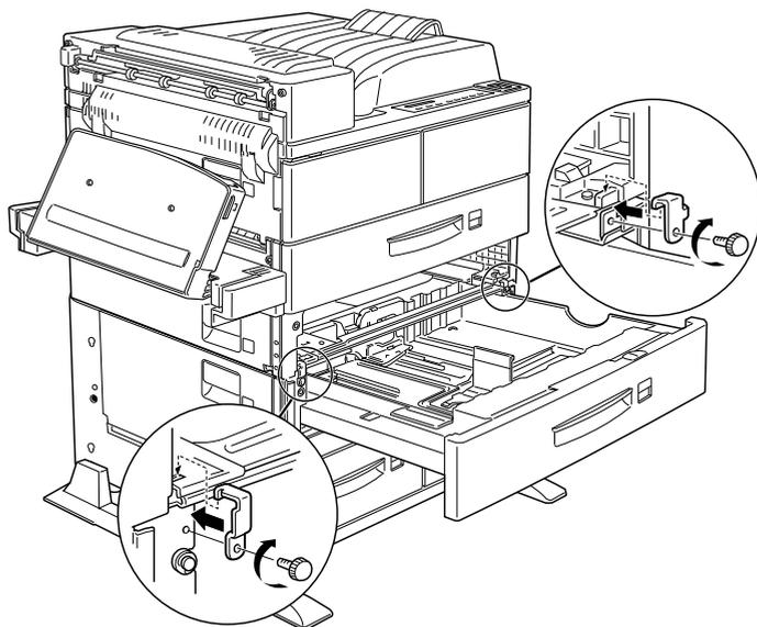
13. Inserte de nuevo la bandeja 3 en la unidad, luego coloque de nuevo la bandeja 2. Tire de la bandeja 4 y retire de su interior los materiales de protección.
