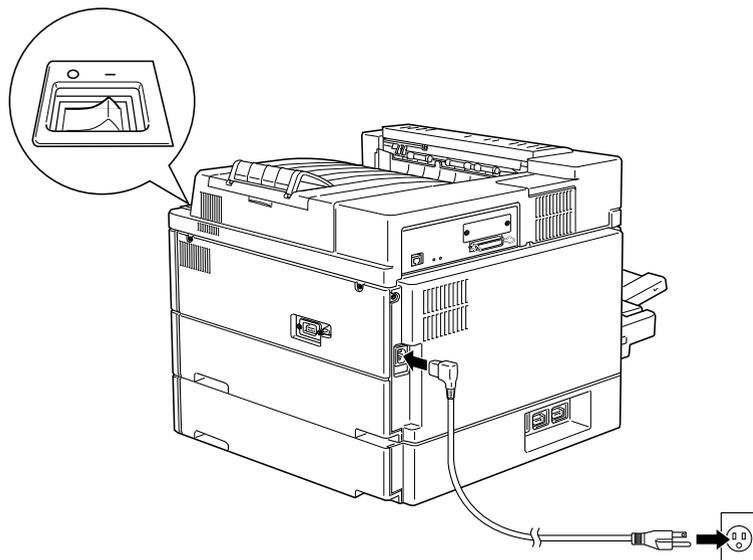
2. Inserte el cable de alimentación en la toma de CA de la parte posterior de la impresora. Luego, conecte el otro extremo a una toma de corriente con derivación a masa.
