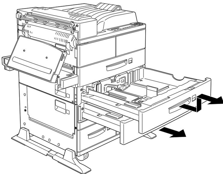
11. Tire de la bandeja inferior 3. Sáquela y abra el paquete incluido de tornillos y piezas metálicas.
