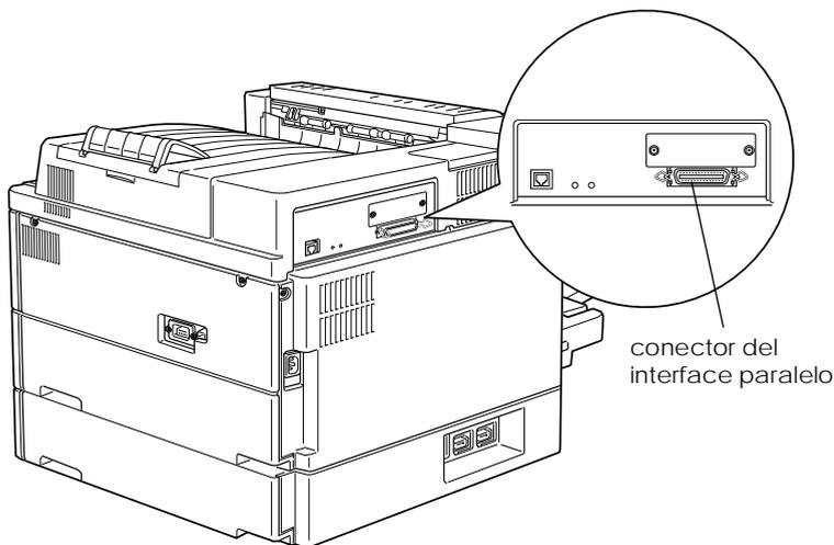
3. Asegure el conector por medio de los dos clips laterales hasta que queden encajados en ambos lados del conector.
