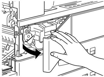
5. Sujetando el cartucho por la empuñadura con una mano y por la pestaña con la otra, inserte por completo el cartucho en el interior de la impresora.
