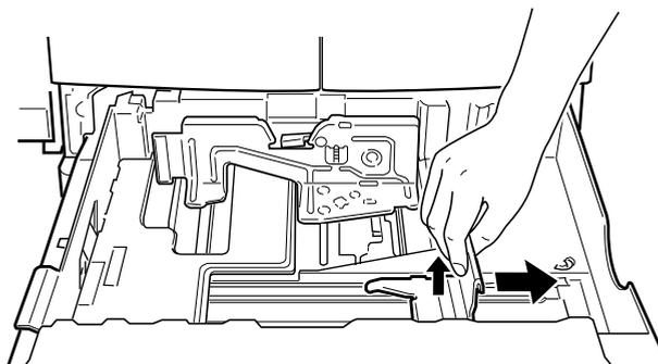
3. Al tiempo que presiona hacia abajo la palanca en la guía horizontal del papel, deslice la guía el máximo hacia el exterior.
