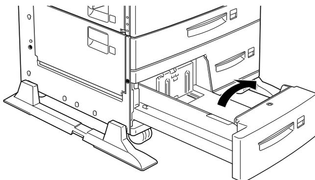
14. Tire de la bandeja inferior 5 y retire los materiales de protección de su interior. Asegúrese de abrir la cubierta interior y eliminar los rellenos de protección.
