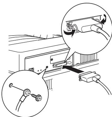
4. Conecte el otro extremo del cable al ordenador, y asegúrelo.
