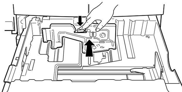
4. Airee una pila de papel y alinéela con unos golpes sobre una superficie plana para nivelar los bordes. Inserte el papel con la cara imprimible hacia arriba en la bandeja del papel, colocando las esquinas del papel en las marcas flecha que se encuentran en el interior de la bandeja.
