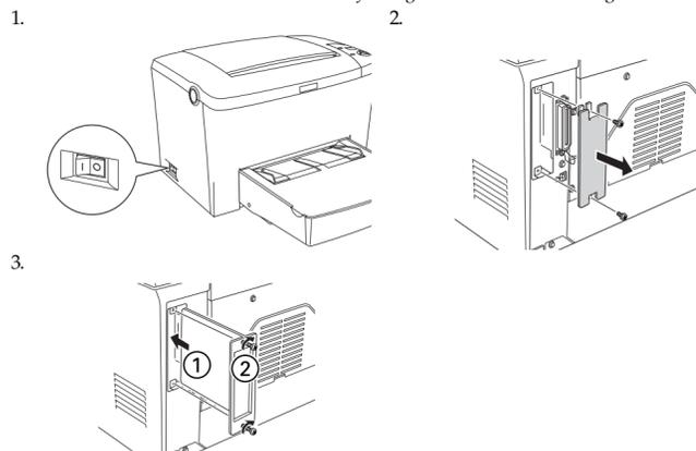
Um sicherzustellen, dass die Schnittstellenkarte korrekt installiert ist, drucken Sie ein Statusblatt aus. Siehe „4 - Testen und Anschließen des Druckers“.
