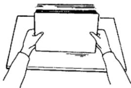
4. Legen Sie den Papierstapel in das Magazin und achten Sie darauf, daß der Papierstapel nur so hoch ist, daß die Markierung im Papiermagazin noch zu sehen ist. Schieben Sie das Papier mit leichtem Druck soweit wie möglich in das Magazin hinein.
