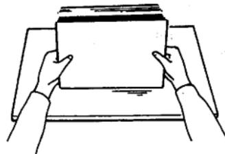
4. Legen Sie den Papierstapel in das Magazin und achten Sie dabei darauf, daß der Papierstapel nur so hoch ist, daß die Markierung für die maximale Papierhöhe im Papiermagazin noch sichtbar bleibt. Schieben Sie das Papier mit leichtem Druck soweit wie möglich in das Magazin hinein.
