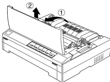
4. Presione las lengüetas de cada lado de la unidad tensora del papel hacia arriba, levante la parte frontal de la impresora y tire de ella hacia arriba hasta sacarla de la impresora.
