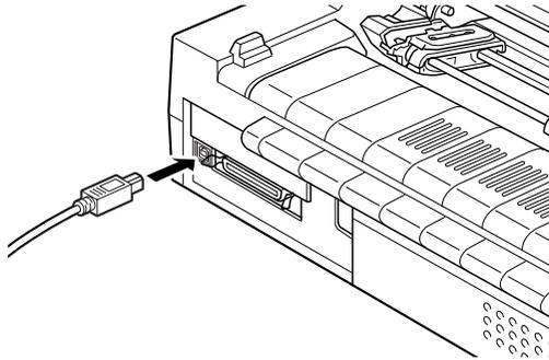
3. Conecte el otro extremo del cable al puerto USB del ordenador.
