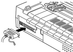
3. Apriete los clips para sujetar el cable hasta que estén colocados firmemente a ambos lados del conector.
