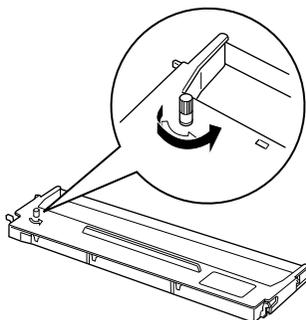
7. Sujete el cartucho de cinta por el asa e insértelo en la impresora como se muestra más abajo. Después, presione los dos lados del cartucho con fuerza para encajar los ganchos de plástico en las ranuras de la impresora.
