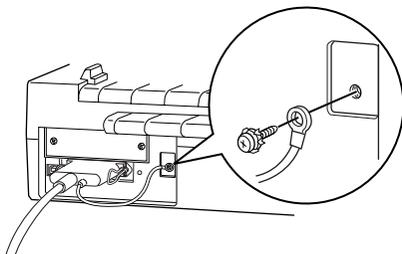
4. Conecte el otro extremo del cable al puerto del interface paralelo del ordenador. (Si hay una derivación a masa en el extremo del cable, conéctela al conector de masa situado en la parte posterior del ordenador.)
