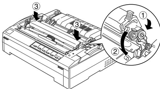
11. Vuelva a colocar la cubierta de la impresora insertando las lengüetas frontales en las ranuras de la impresora y bajando la cubierta hasta colocarla en su sitio. Después, empujela hacia abajo hasta oír un clic.
