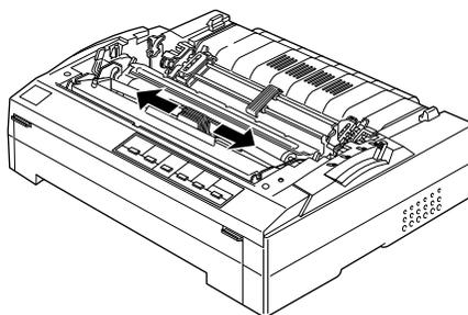
10. Vuelva a instalar la unidad tensora del papel colocándola en los anclajes de montaje de la impresora y bajándola hasta su sitio. Presione los dos laterales de la unidad hasta que quede bloqueada en su sitio.
