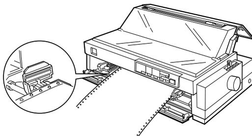
7. Desloque a correia de tracção direita para eliminar possíveis folgas do papel e, em seguida, exerça pressão sobre a patilha de fixação, para a prender.
