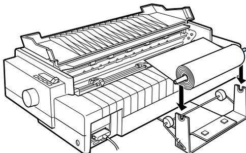
8. Ligue a impressora. Em seguida, puxe a margem inicial do papel até à parte superior do tractor anterior posterior e introduza-o até encontrar resistência. A impressora alimenta o papel em rolo automaticamente.
