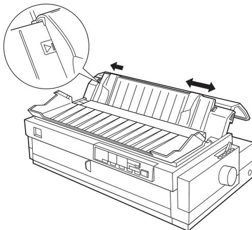
3. Coloque a alavanca de selecção do sistema de alimentação na posição de folhas soltas. Coloque a alavanca reguladora da espessura do papel (situada por baixo da tampa da impressora) na posição correcta, consoante a espessura do papel que vai utilizar (consulte a tabela da secção “Tipos e Entradas de Papel Disponíveis”, neste capítulo).
