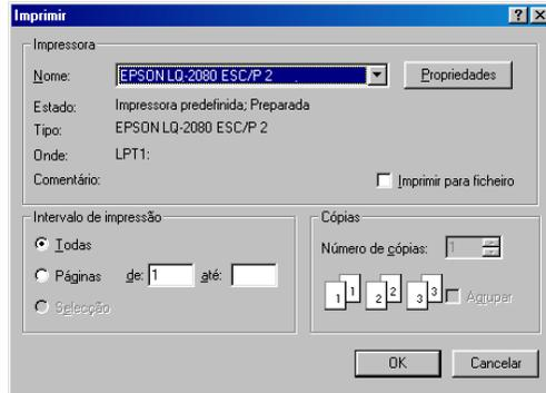
2. Certifique-se de que a impressora que está a utilizar está seleccionada e faça clique em Impressora (Printer), Configurar (Setup), Propriedades (Properties) ou Opções (Options) (pode ser necessário seleccionar uma combinação destas teclas). Aparecerá a janela Propriedades (Properties) que contém os menus Papel e Gráficos. Estes menus contêm as definições do controlador da impressora.
