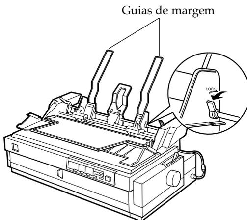
4. Segure na parte inferior do guia de margem esquerdo e desloque-o até ficar alinhado com a seta existente na parte posterior do suporte central. Em seguida, empurre a alavanca de fixação esquerda até prender. Segure na parte inferior do guia de margem direito e desloque-o consoante a largura do papel que vai utilizar, mas não o prenda.
