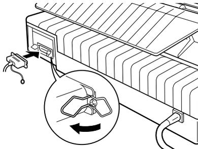
3. Se o cabo possuir um fio de terra, ligue-o ao conector de terra da impressora, conforme indica a figura.
