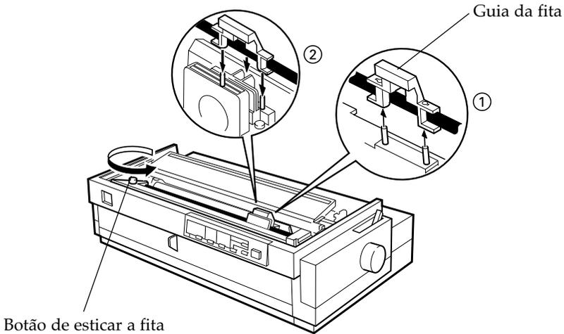
10. Rode o botão de esticar a fita na direcção da seta para eliminar possíveis folgas, conforme indica a figura anterior. Em seguida, desloque a cabeça de impressão de um lado para o outro para se certificar de que desliza sem problemas.
