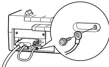
4. Ligue a outra extremidade do cabo ao computador (se o cabo possuir um fio de terra nesta extremidade, ligue-o ao conector de terra existente no painel posterior do computador).
