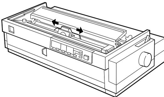
11. Volte a colocar a tampa da impressora, inserindo as patilhas da tampa nos conectores da impressora; em seguida, baixe a tampa até a encaixar.
