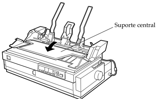
3. Puxe para a frente as alavancas de fixação dos guias de margem, esquerdo e direito, para os soltar.
