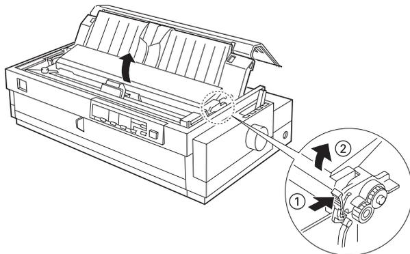
3. Insira o tractor nos conectores da impressora e exerça pressão nas duas extremidades para se certificar de que fica bem encaixado.
