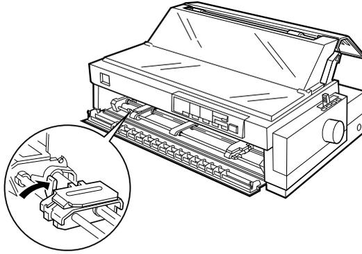
4. Desloque a correia de tracção esquerda para a margem esquerda do papel, assinalada por uma seta no interior da impressora (a impressão começa na posição assinalada pela seta). Em seguida, puxe a patilha para a frente, para a prender.
