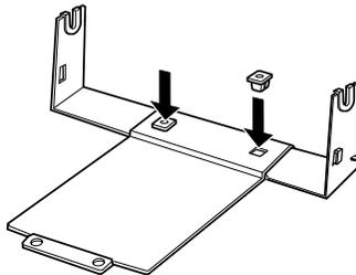
3. Encaixe a alavanca de tensão em ambas as extremidades do suporte, conforme indica a figura. Levante a alavanca de tensão e encaixe as respectivas extremidades nos orifícios existentes no suporte. Está concluída a montagem do suporte de papel em rolo.
