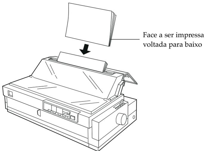
Insira este tipo de formulário na entrada frontal com a margem ligada voltada para o interior da impressora e com a face a ser impressa voltada para cima, conforme indica a figura.
