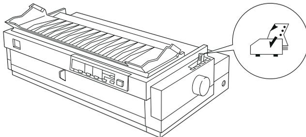
3. Solte as correias de tracção, esquerda e direita, puxando as patilhas de fixação para a frente.
