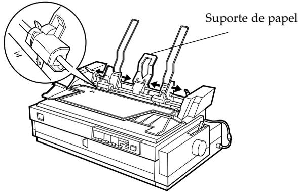
5. Desloque o suporte de papel para o centro dos dois guias de margem, conforme indica a figura anterior.
