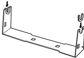
2. Certifique-se de que coloca o suporte e a placa com a orientação indicada na figura. Em seguida, coloque a placa no suporte e prenda os dois elementos com os cliques de plástico.
