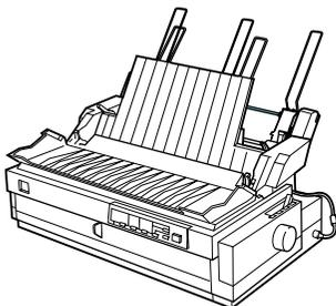
Encaixa no alimentador de alta capacidade para criar um alimentador duplo. Pode colocar até 50 folhas soltas de papel normal no segundo receptor do alimentador. Para saber como utilizar esta opção, consulte a secção “Utilizar os Alimentadores Opcionais”, neste apêndice.
