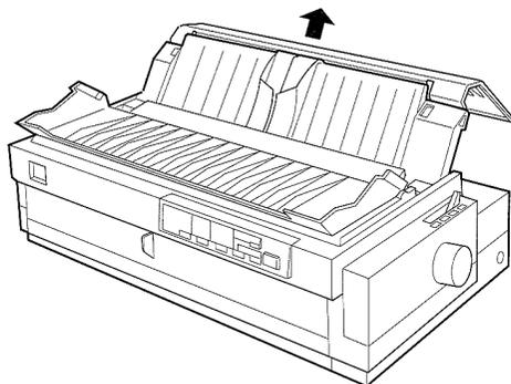
2. Coloque a alavanca de selecção do sistema de alimentação na posição de tractor anterior posterior. Ajuste a alavanca reguladora da espessura do papel (situada por baixo da tampa da impressora) consoante a espessura do papel que vai utilizar.
