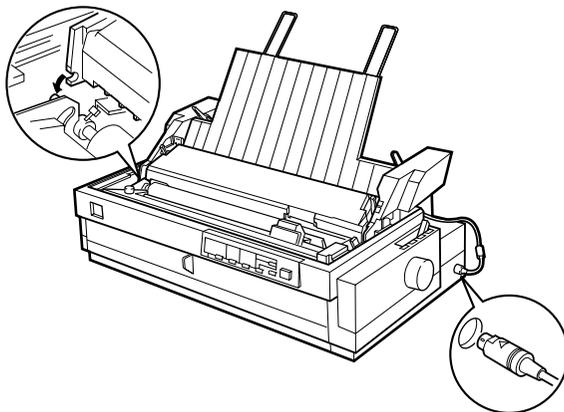
5. Insira o cabo no conector, conforme indica a figura anterior.
