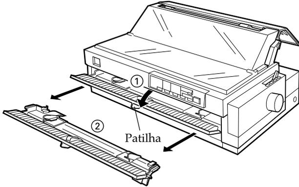
3. Insira o tractor nos conectores da impressora e exerça pressão sobre as duas extremidades do tractor para se certificar de que está encaixado.
