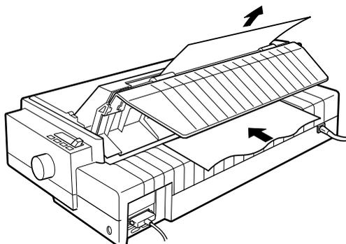
Quando acabar de imprimir, abra o guia da trajectória do papel e pressione a tecla LF/FF para fazer avançar o papel. Em seguida, utilize a aresta de corte da impressora para cortar o papel (puxe o papel na sua direcção para o cortar correctamente).
