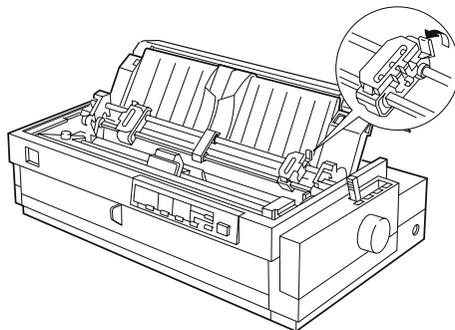
5. Oriente-se pela régua existente na parte de trás do tractor para deslocar a correia de tracção esquerda até à respectiva margem (a impressão começa no local assinalado pela seta). Em seguida, pressione a patilha de fixação até prender a correia.
