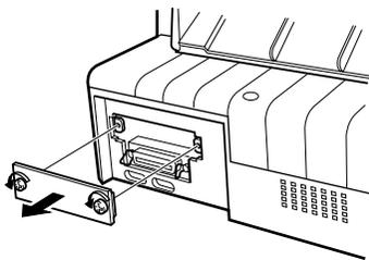
3. Faça deslizar a placa de interface ao longo de ambas as ranhuras existentes no compartimento de interface. Introduza a placa com firmeza para se assegurar de que o conector existente na parte posterior da placa está completamente inserido no conector interno da impressora. Em seguida, volte a colocar os parafusos e aperte-os.
