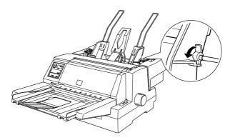
3 Posicione o guia de margem direito de forma a que a respectiva extremidade fique alinhada com a marca situada no alimentador e empurre a alavanca para trás para fixar o guia de margem. Em seguida, ajuste o guia de margem esquerdo em função da largura do papel.
