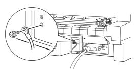
5 Ligue a outra extremidade do cabo ao interface paralelo do computador. Se o cabo possuir um fio de terra, ligue-o ao conector de terra existente no painel posterior do computador.
