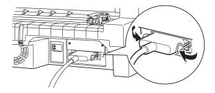
4 Se o cabo possuir um fio de terra, ligue-o ao conector de terra, conforme indica a figura.
