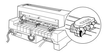
4 Com o painel posterior da impressora voltado de frente para si, posicione a correia de tracção esquerda de forma a que os pinos fiquem à esquerda do "0" e da seta existentes na impressora. Em seguida, baixe a alavanca para fixar a correia.
