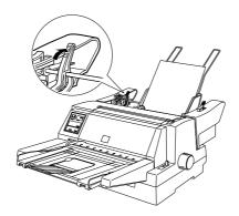
Antes de imprimir, certifique-se de que a alavanca de selecção do sistema de alimentação se encontra na posição de folhas soltas. Coloque também a alavanca reguladora da espessura do papel na posição adequada ao tipo de papel introduzido no alimentador, conforme o descrito no Capítulo 3. No controlador da impressora, seleccione o formato de papel e o alimentador automático de folhas 1 (Sheet Feeder - Bin 1).
