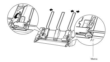
Alimente um maço de papel (com um máximo de 50 folhas), depois de o alinhar e folhear, encostando a margem direita do papel ao guia de margem direito. Coloque o papel com a face a ser impressa voltada para cima. Ajuste o guia de margem esquerdo e o suporte central ao papel e, em seguida, empurre para trás as alavancas para fixar o papel.
