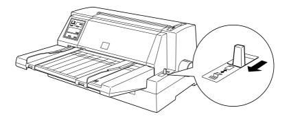
2 Desloque os guias de margem completamente para os lados.
