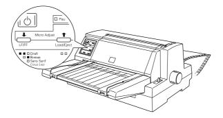
4 Quando o papel estiver correctamente posicionado, pressione a tecla de pausa para desactivar o modo de micro-ajuste e continuar a imprimir.
