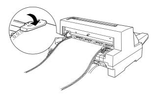
10 Desloque a correia de tracção direita para eliminar possíveis folgas existentes no papel. Em seguida, baixe a alavanca da correia para a fixar.
