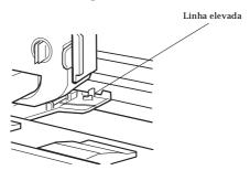
Depois de definir a posição de alimentação, pressione a tecla de pausa para desactivar o modo de micro-ajuste.
