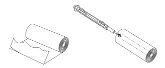
2 Coloque o rolo de papel no suporte do rolo. Posicione o rolo de forma a que o papel seja alimentado pela parte superior e a margem do papel passe por baixo da alavanca de tensão. Em seguida, pressione a tecla de funcionamento (Operate) para ligar a impressora.
