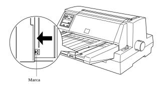
5 Ajuste o guia de margem esquerdo em função da largura do papel e introduza uma folha de papel entre os guias até encontrar resistência. Coloque o papel com a face a ser impressa voltada para cima.
