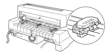
2 Coloque a alavanca de selecção do sistema de alimentação na posição de folhas soltas, indicada na figura. Se utilizar folhas soltas de papel normal, certifique-se ainda de que a alavanca reguladora da espessura do papel está na posição "0".
