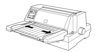
3 Liberte as alavancas de fixação das correias de tracção, conforme indica a figura.
