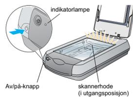
**Merk:** Lysstoffrøret på skanneren slås av hvis skanneren ikke mottar kommandoer fra datamaskinen i løpet av 15 minutter.
