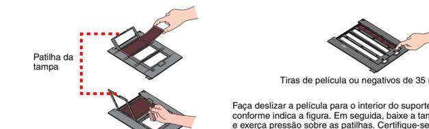
Coloque o suporte para película no digitalizador, tal como indica a figura. Certifique-se de que o suporte está direccionado para o canto superior direito do digitalizador.
