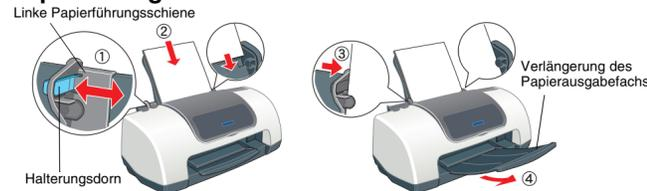
Um die linke Papierführungsschiene auszurichten, drücken Sie den Halterungsdorn und schieben die Papierführungsschiene an den Papierstapel heran.
