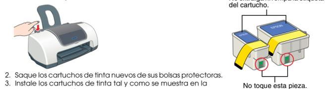
**Nota:** Instale todos los cartuchos de tinta. La impresora no funcionará hasta que todos los cartuchos estén correctamente instalados.
