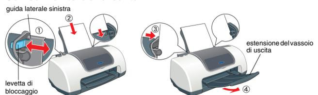
Per regolare la guida laterale sinistra, tenere premuta la levetta di bloccaggio e spostare la guida contro la risma di carta.
