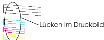
Druckkopf muss gereinigt werden
