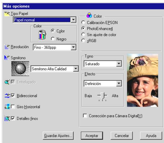
2. Seleccione el tipo de papel cargado en la impresora. Consulte los detalles en la sección “Determinar el ajuste de Tipo papel” en la página 2-5.
