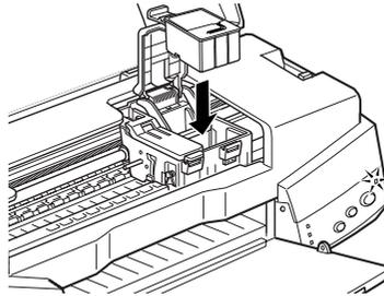
8. Presione la abrazadera del cartucho de tinta hasta que quede bloqueada en su posición.
