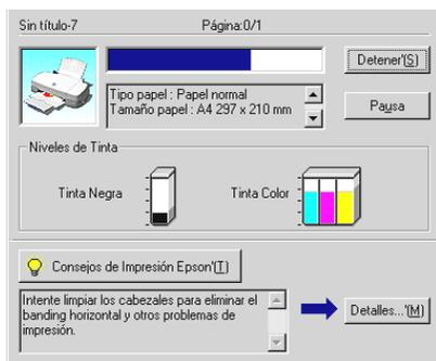
El Contador de Avance indica el progreso del trabajo de impresión actual y muestra el estado de la impresora al establecerse la comunicación bidireccional entre la impresora y el ordenador. Además ofrece consejos útiles para mejorar la impresión y muestra mensajes de error, tal como se detalla a continuación.
