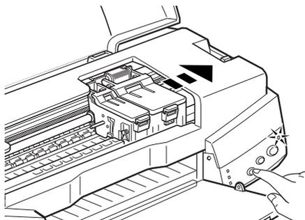
La impresora empieza la limpieza del cabezal de impresión y el indicador de alimentación
