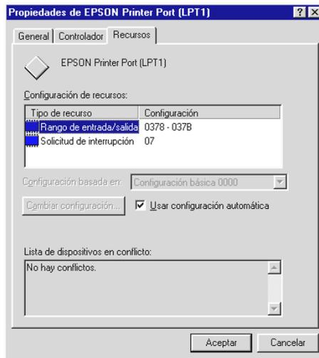
5. Seleccione un ajuste de configuración básica en la lista Configuración basada en, que utiliza los mismos ajustes de Rango de Entrada/Salida que los anotados en el Paso 4, y compruebe que los números del canal de Acceso directo a memoria y de Solicitud de interrupción estén asignados y visualizados. Compruebe también que el cuadro Lista de dispositivos en conflicto muestre No hay conflictos.
