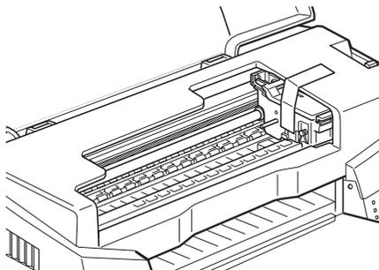
5. Pliegue la ampliación de la bandeja de salida y levante esta bandeja.
