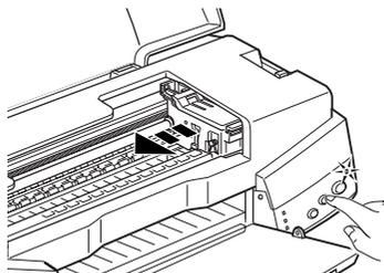
4. Levante la abrazadera del cartucho de tinta adecuada. A continuación, extraiga el cartucho de tinta de la impresora y deséchelo de forma adecuada.
