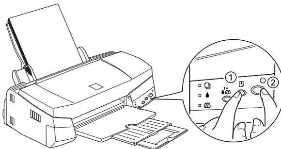
Se imprimirá una página de comprobación del funcionamiento que incluye la versión de la ROM de la impresora, el código del contador de tinta y un patrón de comprobación de los inyectores.
