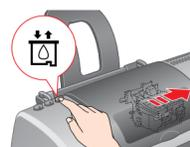
Der Drucker beginnt mit der Aktivierung des Tintenzuleitungssystems. Dieser Vorgang dauert etwa 1,5 Minuten. Bei der Aktivierung des Tintenzuleitungssystems erzeugt der Drucker verschiedene mechanische Geräusche. Dies ist normal. Der Aktivierungsvorgang ist beendet, wenn die grüne Anzeige aufhört zu blinken.
