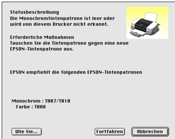
Sie können mit diesem Utility vor dem Drucken auch den Tintenfüllstand der Patronen überprüfen. Wenn EPSON StatusMonitor geöffnet ist, wird der Füllstand der Tintenpatronen zum Zeitpunkt des Utility-Aufrufs angezeigt. Durch Klicken in das Feld **Aktualisieren** können Sie den neuesten Füllstand abfragen.
