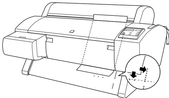
5. Mettez le levier de maintien du papier en position de maintien. L'indication `APPUYEZ SUR PAUSE` apparaît sur l'écran LCD.
