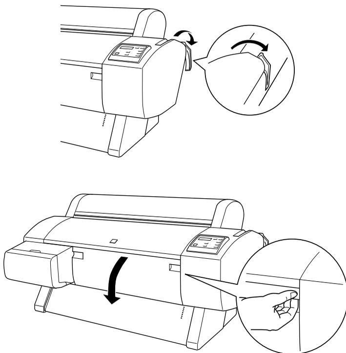
5. Chargez la feuille dans la fente d'insertion du papier de sorte que le bord inférieur du papier repose derrière le capot avant ouvert. Assurez-vous que le bord droit est vertical et aligné sur la rangée verticale de perforations.
