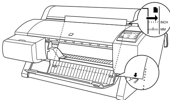
6. Mettez le levier de maintien du papier en position de maintien et fermez le capot avant. L'indication `APPUYEZ SUR PAUSE` apparaît sur l'écran LCD.
