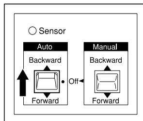
3. Envoyez un travail d'impression à l'imprimante. L'imprimante commence à imprimer. L'enrouleur automatique enroule le papier rouleau dans le sens défini à l'étape 2.
