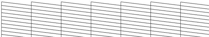
nettoyage des têtes nécessaire
