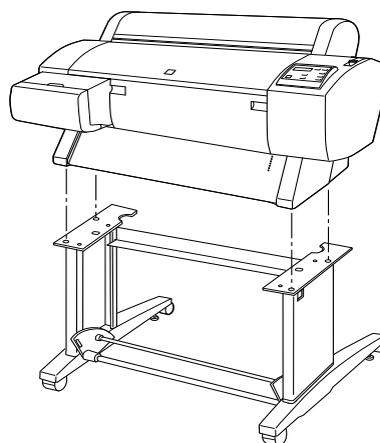
3. Fissare il fondo della stampante e il supporto della stampante con le viti ad alette (N) e le rondelle (O).
