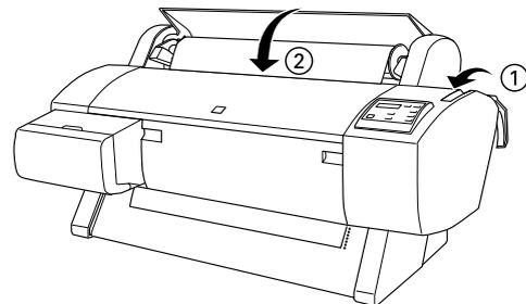
11. Premere il tasto PAUSE. Le testine di stampa si spostano e la carta viene alimentata automaticamente fino alla posizione di stampa. Sul pannello LCD appare PRONTA.
