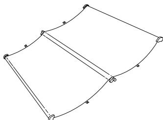
4. Tenendo l'asta posteriore, farla passare sotto le traverse orizzontali. Far fare all'asta un giro come mostrato di seguito. Inserire quindi i perni di ancoraggio nei fori sul montante base sinistro e destro.
