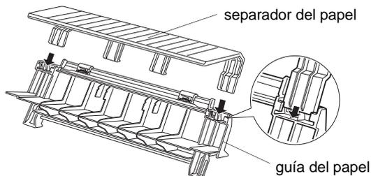
2. Compruebe que la cubierta de la guía del papel esté abierta, tal como se muestra a continuación. Instale la guía del papel insertando las ranuras de la parte inferior de la guía del papel en los anclajes situados detrás de la unidad tensora del papel.
