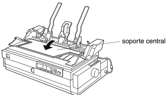
3. Suelte las guías laterales izquierda y derecha del papel del alimentador de hojas sueltas tirando de las palancas hacia delante.
