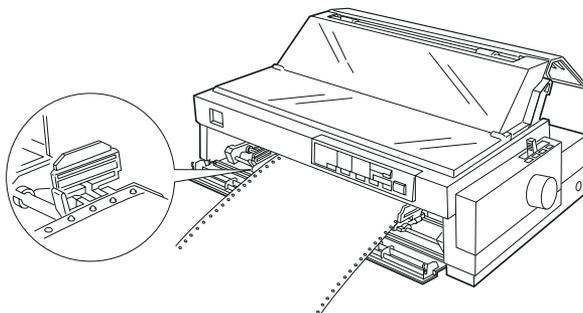
7. Desplace la unidad de arrastre derecha para tensar el papel; a continuación, bloquéela presionando hacia abajo el pestillo de bloqueo.
