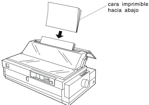
Inserte este tipo de impresos en la ranura frontal por el borde ligado y con la cara imprimible hacia arriba, tal como muestra la siguiente figura.
