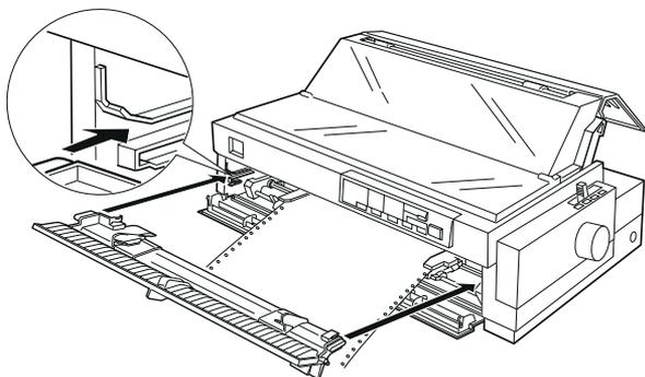
9. Desplace las guías laterales hasta el centro de la guía superior del papel. Compruebe que la cubierta de la impresora y que la cubierta de la guía del papel estén cerradas.
