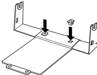
3. Instale la palanca de tensión en los dos extremos del soporte, tal como muestra la siguiente figura. Tire de la palanca de tensión hacia arriba para insertar los extremos de la palanca de tensión en los orificios del soporte. El soporte para el papel en rollo estará montado.
