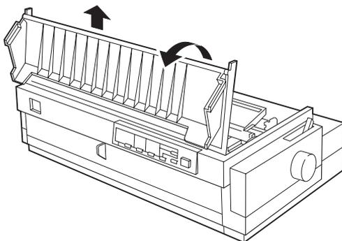
4. Compruebe que el cabezal impresor no se encuentre a una temperatura demasiado alta; si lo está, déjelo enfriar unos minutos antes de tocarlo. A continuación, desplace manualmente el cabezal impresor hasta la posición de instalación de la cinta (la parte dentada de la unidad tensora del papel).
