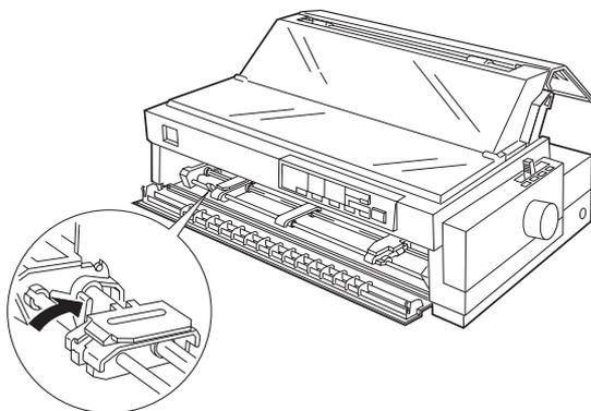
4. Desplace la unidad de arrastre izquierda hasta el margen izquierdo del papel utilizando la marca de la flecha del interior de la impresora. (La impresión empieza en la marca de la flecha). A continuación, tire de la palanca hacia delante para bloquearla.
