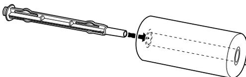
7. Coloque el eje y el papel en rollo en el soporte para el papel en rollo, de manera que el papel avance desde la parte inferior del rollo.
