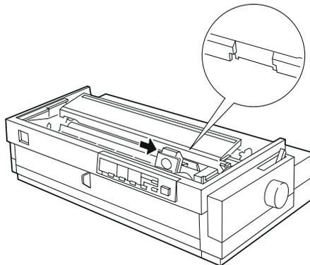
5. Si ya hay un cartucho de cinta instalado, sujételo y sepárelo de la impresora tirando de él hacia delante y ligeramente hacia arriba; la guía de la cinta se separará de los pins metálicos situados detrás del cabezal impresor. Deshágase del cartucho de tinta gastado.
