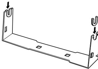
2. Compruebe que orienta el soporte y la base tal como muestra la siguiente figura. A continuación coloque la base sobre el soporte y fíjelos con los clips de plástico.
