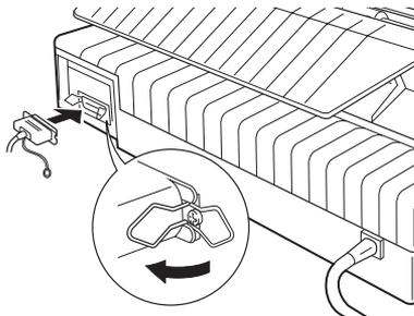
3. Si el cable dispone de un cable para la conexión a masa, conéctelo a la toma de masa de la impresora tal como se indica en la figura siguiente.
