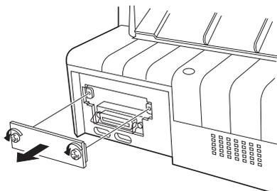
3. Introduzca la tarjeta de interface siguiendo las guías de los lados del compartimento del interface. Introduzca la tarjeta con firmeza para que el conector de la parte posterior quede totalmente insertado en el zócalo interno de la impresora. Vuelva a colocar los tornillos.
