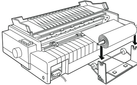
8. Active la impresora. Haga pasar el borde frontal del papel por encima del tractor posterior e insértelo hasta que note una cierta resistencia. La impresora cargará el papel automáticamente.
