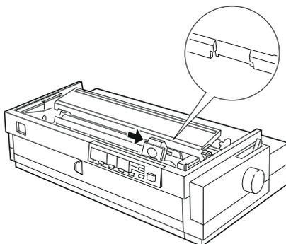
5. Sujete el cartucho de cinta usado y tire de él hacia arriba, extrayéndolo de la impresora.
