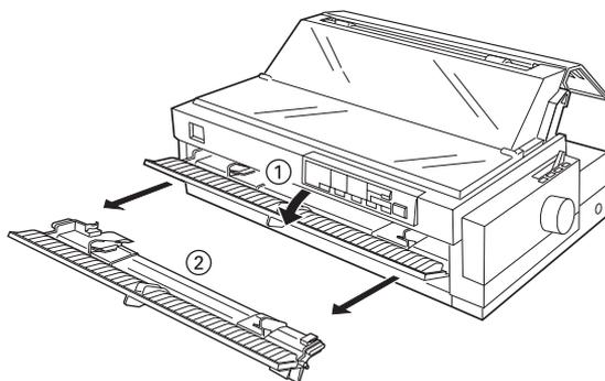
3. Inserte el tractor en las ranuras de montaje de la impresora y presione hacia abajo ambos extremos del tractor para que quede firmemente asentado.
