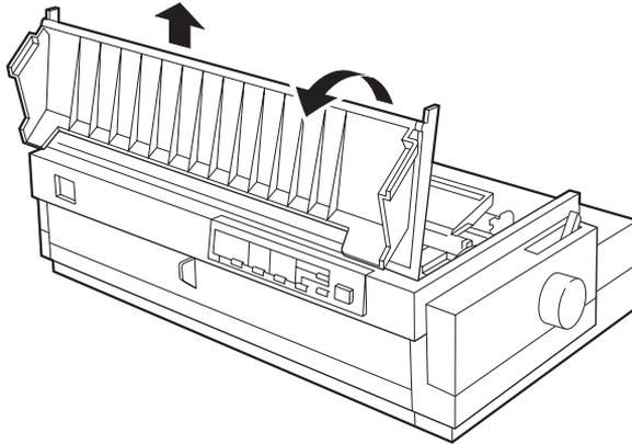
4. Compruebe que el cabezal impresor no se encuentre a una temperatura demasiado elevada; si es así, déjelo enfriar unos minutos antes de tocarlo. A continuación, desplace manualmente el cabezal impresor hasta la posición de instalación de la cinta (la parte dentada de la unidad tensora del papel).
