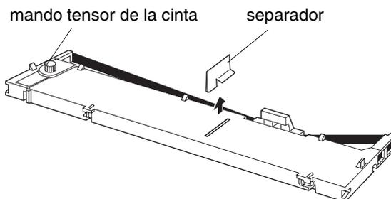
7. Sostenga el cartucho encarando el mando tensor de la cinta hacia arriba. Introduzca las dos muescas más cercanas a usted (1) en los pequeños anclajes situados a cada lado de la impresora, tal como muestra la figura. A continuación, coloque el cartucho plano de forma que las otras muescas (2) encajen en sus correspondientes anclajes.
