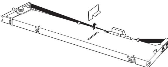
Deberá substituir el cartucho de cinta cuando observe que se debilita la impresión. Los cartuchos de cinta originales EPSON están diseñados y fabricados para trabajar con esta impresora EPSON. Estos cartuchos garantizan un funcionamiento sin problemas y una larga duración del cabezal impresor y de las otras partes de la impresora.
