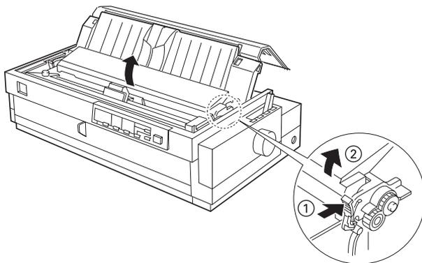
3. Coloque el tractor en las ranuras de montaje de la impresora y ejerza presión sobre ambos extremos del tractor para que quede firmemente asentado.
