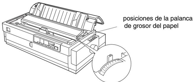
Utilice las indicaciones de la tabla siguiente para seleccionar una posición de la palanca y ajustar el grosor del papel.
