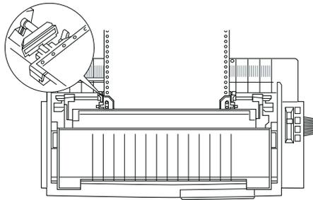
7. Desplace la unidad de arrastre derecha para tensar el papel; a continuación, bloquéela presionando hacia abajo el pestillo de bloqueo.
