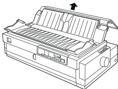
2. Coloque la palanca de liberación del papel en la posición de tractor posterior. Igualmente, coloque la palanca de grosor del papel (situada debajo de la cubierta de la impresora) en la posición correspondiente al grosor del papel que vaya a utilizar.
