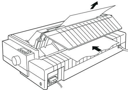
Al terminar de imprimir, abra la cubierta de la guía del papel y pulse el botón LF/FF para hacer avanzar el papel. A continuación corte el papel utilizando el borde de corte de la impresora (para un corte limpio, tire del papel tal como muestra la figura).
