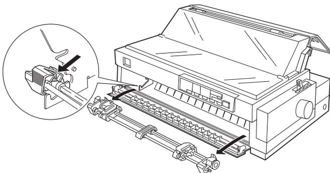
5. Vuelva a colocar la guía frontal del papel deslizándola en las ranuras de montaje de la impresora hasta que quede bloqueada. A continuación, cierre la guía frontal del papel.
