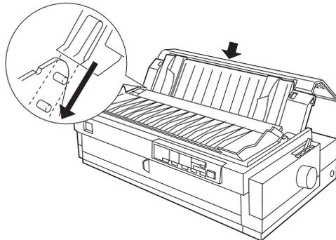
4. Cierre la cubierta de la guía del papel, y compruebe que la palanca de liberación del papel esté colocada en la posición de tractor posterior.
