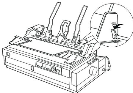
4. Coja la guía lateral izquierda del papel por la parte inferior y desplácela hasta que quede alineada con la flecha de la parte posterior del soporte central. A continuación pulse la palanca de bloqueo izquierda para fijar la guía lateral. Coja la guía lateral derecha por la parte inferior y desplácela hasta que coincida con la anchura del papel, pero no fije la guía lateral.
