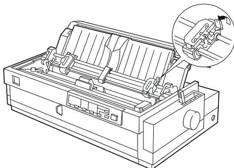
5. Desplace la unidad de arrastre izquierda hasta el margen izquierdo del papel utilizando la escala de la guía del papel como referencia. (La impresión empieza en la marca de la flecha). A continuación, empuje la palanca hacia atrás para bloquearla.
