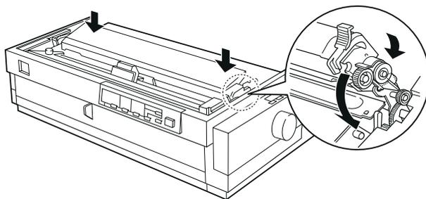
6. Vuelva a colocar la guía del papel y la cubierta de la impresora. A continuación, cierre la cubierta de la guía del papel.
