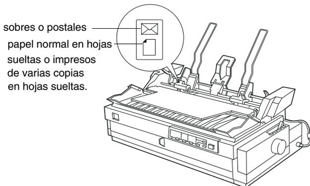
7. Tire de ambas palancas de ajuste del papel hacia delante hasta que las guías se retraigan y se abran para permitir la carga de papel.
