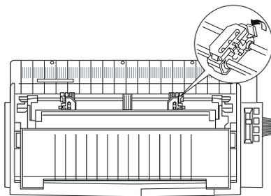
4. Desplace la unidad de arrastre izquierda hasta el margen izquierdo del papel utilizando la escala de la impresora. (La impresión empieza en la marca "0"). A continuación, empuje la palanca hacia atrás para bloquearla.
