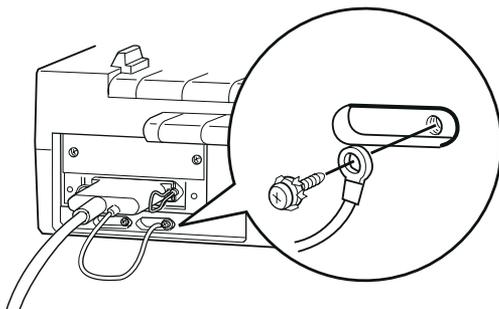
4. Conecte el otro extremo del cable al ordenador. (Si el cable tiene una toma de masa en el extremo del ordenador, conéctelo al conector de masa de la parte posterior del ordenador).
