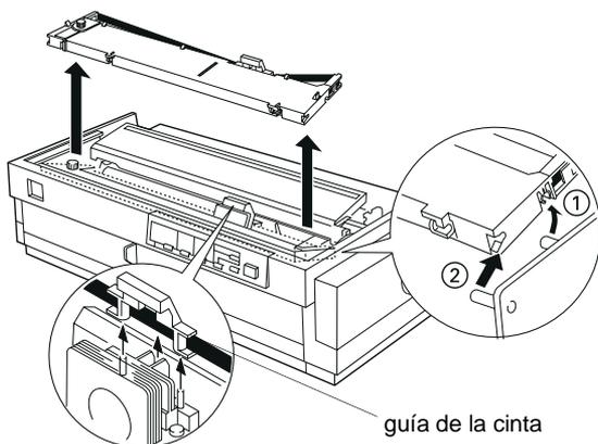
6. Retire el nuevo cartucho de cinta de su envoltorio. Extraiga el separador situado en el centro del cartucho de cinta y deshágase de él. A continuación, gire el mando de tensión de la cinta en la dirección de la flecha para tensar la cinta.
