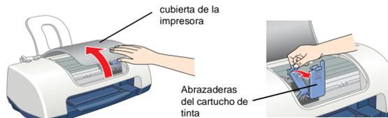
**Precaución:** No mueva el cabezal de impresión con la mano, ya que podría dañar la impresora.
