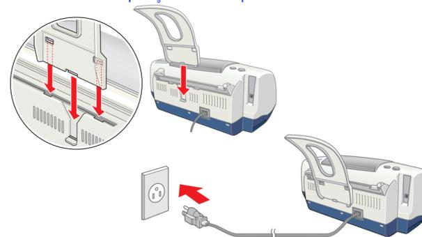
**Importante:** Se a impressora se activar quando ligar o cabo de alimentação, prima o botão de alimentação até apagar o indicador para desligar a impressora.
