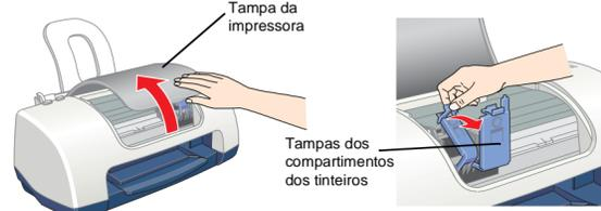
**Importante:** Não desloque a cabeça de impressão com as mãos porque pode danificar a impressora.
