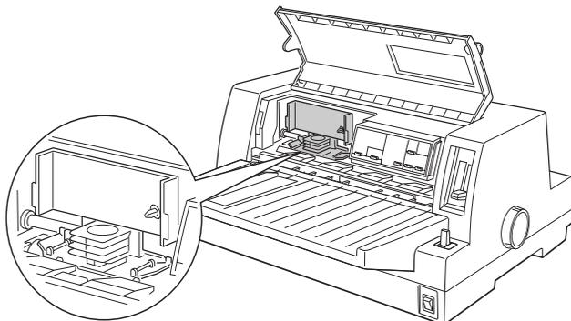
Si ce n'est pas le cas, fermez le capot de l'imprimante et mettez-la sous tension pour que la tête d'impression se déplace jusqu'à la position de remplacement. Attendez quelques secondes, puis mettez de nouveau l'imprimante hors tension et ouvrez son capot.
