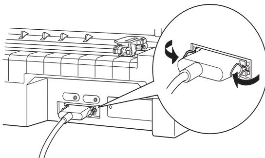
4. Si votre câble est muni d'un fil de masse, connectez ce dernier au connecteur de masse de l'imprimante, de la manière indiquée ci-dessous.
