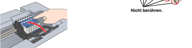
**Hinweis:** Setzen Sie alle Tintenpatronen ein. Dieses Produkt funktioniert erst, wenn alle Tintenpatronen korrekt installiert sind.
