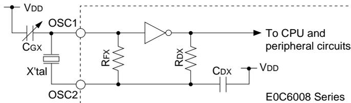
Fig. 4.3.2.1 OSC1 oscillation circuit
