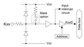
Fig. 5.4.1.1 Structure of input port
