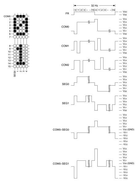
Fig. 5.11.4.2 Drive waveform for 1/16 duty
