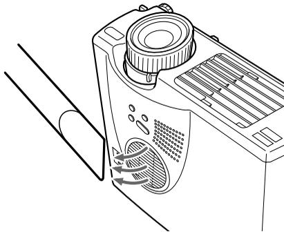
3. Utiliser un petit aspirateur conçu pour les ordinateurs ou autres appareils de bureautique pour nettoyer le filtre. S'il est difficile d'enlever la saleté ou si le filtre est déchiré, le remplacer. Contacter le revendeur ou appeler le Centre de service EPSON.
