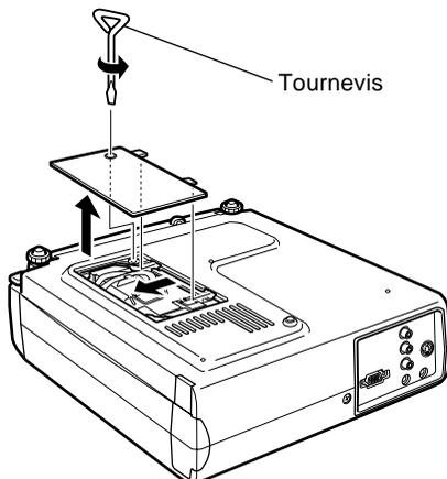
3. Desserrer les deux vis de montage de la lampe avec le même tournevis et sortir la lampe par la poignée.
