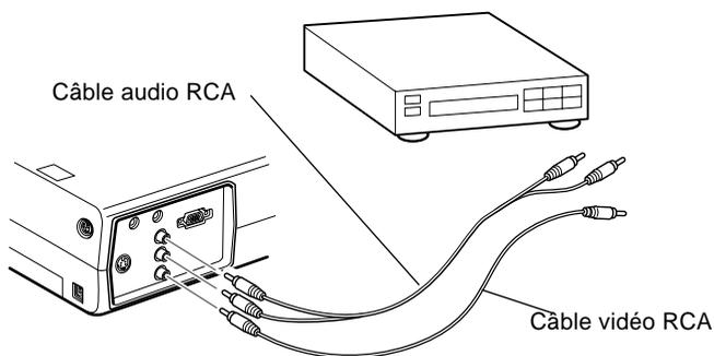
4. Raccorder le câble audio RCA aux bornes Audio du projecteur: insérer la fiche blanche dans la borne L et la fiche rouge dans la borne R. Raccorder la fiche de l'autre extrémité du câble audio RCA à la prise de sortie audio de la source vidéo.
