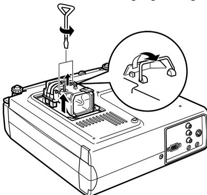
4. Insérer la lampe neuve. Vérifier que la lampe est correctement orientée, puis appuyer dessus pour bien la mettre en place. Serrer les vis de montage de la lampe avec le tournevis.
