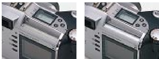
Dispositivo per la retroilluminazione del visore: quando è aperto la luce solare entra dalla fessura
