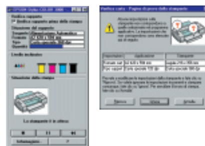
Attraverso il driver si visualizzano sul monitor tipo, formato e quantità di carta selezionata, e livello di inchiostro rimasto. Viene inoltre segnalato se la carta selezionata sul driver è diversa, per tipo e dimensioni, da quella presente nel cassetto.
