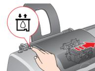
A impressora começa a carregar a tinta. Este processo demora cerca de **um minuto e meio**. Durante o processo de carregamento da tinta, a impressora emite vários sons mecânicos. Esta situação é normal. Quando a lâmpada verde parar de piscar, isso significa que o processo de carregamento da tinta está concluído.
