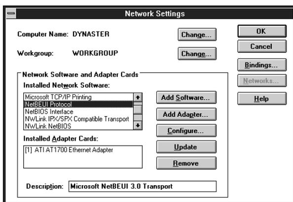
2. Si celui-ci n'y figure pas, cliquez sur Add Software (Ajouter logiciel). Sélectionnez NetBEUI Protocol (Protocole NetBEUI) dans le menu déroulant Network software (Logiciel réseau), puis cliquez sur Continue (Continuer) pour ajouter NetBEUI.
