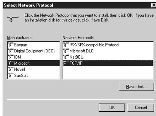
6. Double-cliquez sur TCP/IP dans le menu Configuration pour ouvrir la boîte de dialogue TCP/IP Properties (Propriétés TCP/IP). Effectuez les paramétrages nécessaires tels que le paramétrage de l'adresse IP.
