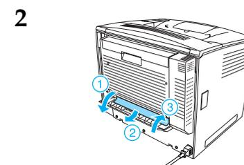
Si l'erreur relative au bourrage papier n'est pas effacée, retirez l'unité recto verso de l'imprimante. Déterminez ensuite si du papier n'est pas coincé dans l'ouverture à l'arrière de l'imprimante.
