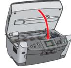
Die Aktivierung des Tintenzuleitungssystems startet. Dieser Vorgang dauert ca. zwei Minuten.
