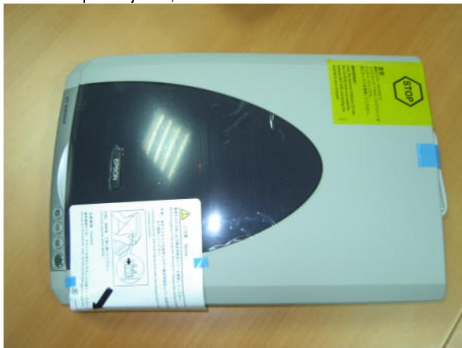
Sous le scanner, basculer le levier de blocage chariot en position déverrouillée.
