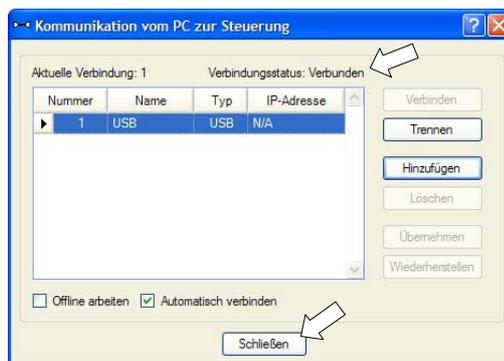
Die Verbindung von PC und Steuerung ist abgeschlossen. Das Robotersystem kann jetzt über die EPSON RC+-Software gesteuert werden.
