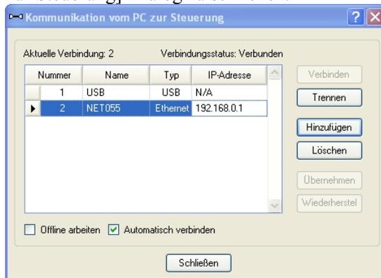
Die Verbindung von PC und Steuerung ist abgeschlossen. Das Robotersystem kann jetzt per Ethernet über die EPSON RC+-Software gesteuert werden.
