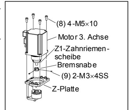
(10) Entfernen Sie die Bremse von der Bremsplatte.
