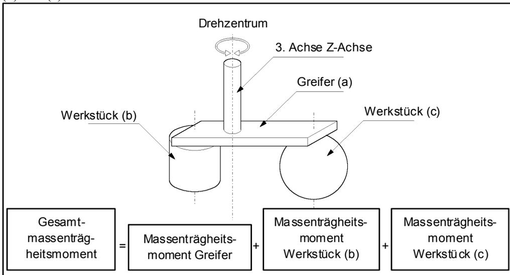
Die Methoden zur Berechnung des Massenträgheitsmoments für (a), (b) und (c) sind im Folgenden dargestellt. Berechnen Sie das Gesamtträgheitsmoment mithilfe der Basis-Formeln.
