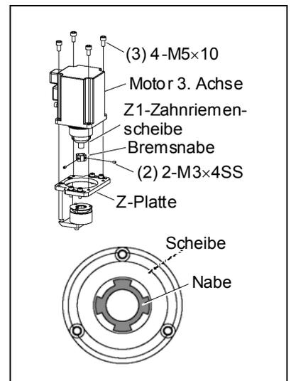
(4) Montieren Sie die Bremseinheit der 3. Achse am 2. Arm so, dass die offene Seite in Richtung Armende zeigt.
