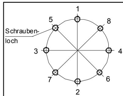
Ziehen Sie die Schrauben nicht in einem Zug fest. Ziehen Sie die Schrauben mit zwei oder drei Zügen fest. Verwenden Sie dafür einen Sechskant-Schlüssel. Verwenden Sie anschließend einen Drehmomentschlüssel, sodass die Schrauben mit den oben in der Tabelle aufgeführten Anzugsmomenten angezogen werden.
