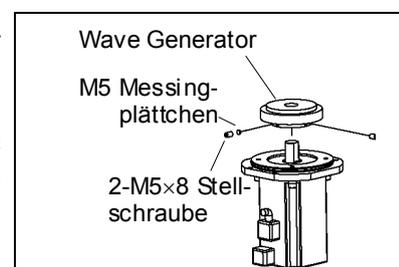
(6) Entfernen Sie den Motorflansch des Motors.
