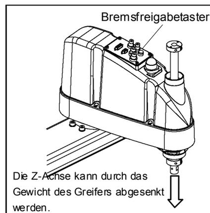
(G6-\*\*\*3\*\*) Um einen Greifer anzubringen, schalten Sie die Steuerung EIN und bewegen Sie die Achse auf bzw. ab oder drehen Sie die Achse, während Sie den Bremsfreigabetaster drücken.
