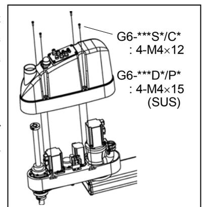
Setzen Sie die obere Armabdeckung wieder auf den Arm und sichern Sie sie mit den zugehörigen Befestigungsschrauben.
