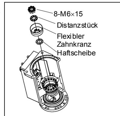
(6) Entfernen Sie den äußeren Zahnkranz vom Sockel.
