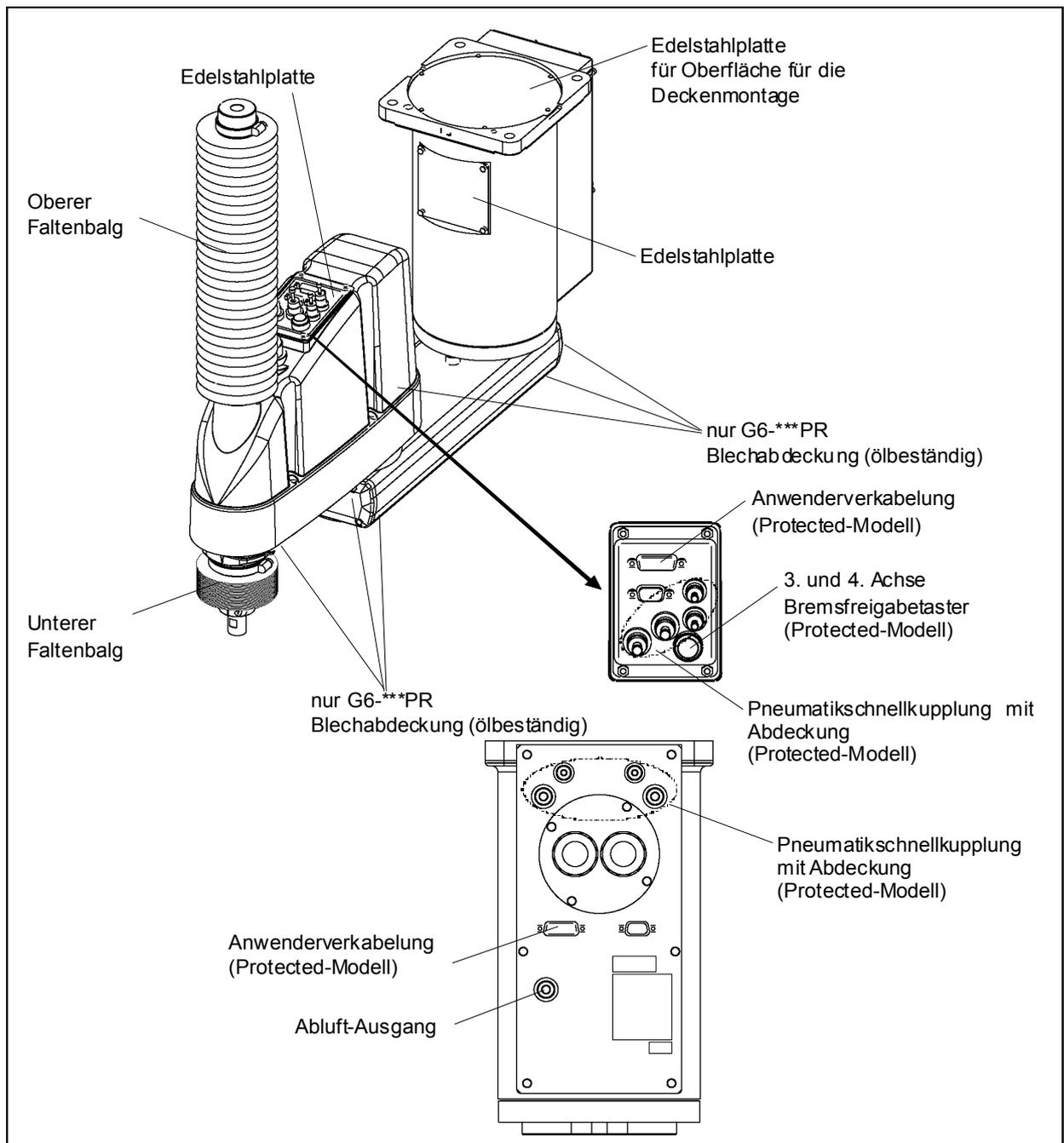
**HINWEIS** Bei dem Protected-Modell sind alle äußeren Schrauben aus Edelstahl.
