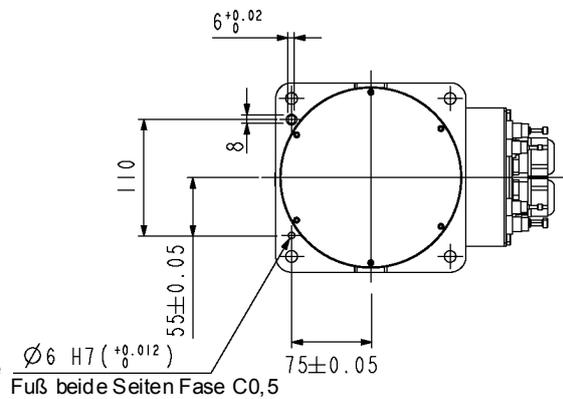
Referenz-Durchgangsbohrung (Ansicht Sockelboden)
