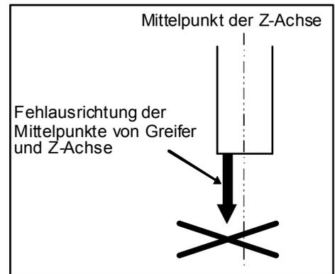
Verwenden Sie eine Kalibriervorrichtung wie in der Abbildung rechts und setzen Sie diese auf das Ende der Z-Achse, um den Achsmittelpunkt darzustellen.
