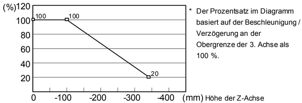
Wenn Sie den Manipulator horizontal verfahren, während die Z-Achse abgesenkt ist, kann dies zu einem Überschwingen an der Zielposition führen.
