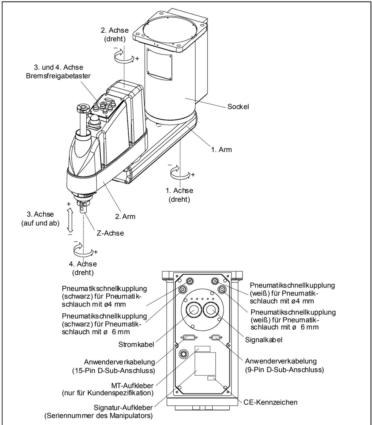
**HINWEIS** Der Bremsfreigabetaster ist mit den Bremsen der 3. und der 4. Achse verbunden. Wenn dieser Taster im Not-Aus-Modus betätigt wird, werden gleichzeitig die Bremsen beider Achsen gelöst. (G6-\*\*\*1\*\*: Bei diesem Modell hat die 4. Achse keine Bremse.)
