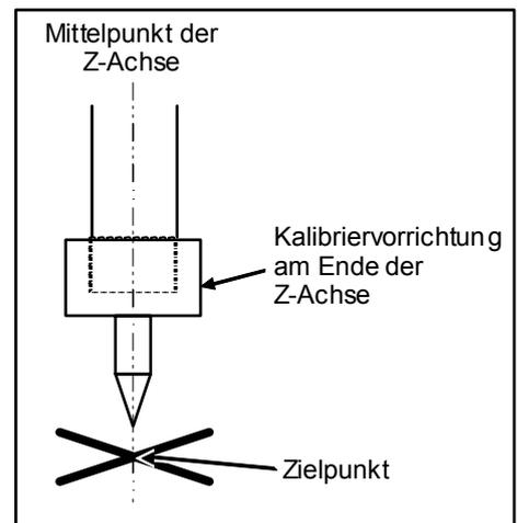
Montieren Sie den Greifer nach der Kalibrierung wieder und bewegen Sie den Manipulator an den Teach-Punkt, um zu überprüfen, ob eine Positionsabweichung vorliegt. Wenn dies der Fall ist, justieren Sie die Installationsposition des Greifers und teachen Sie diese Position erneut.
