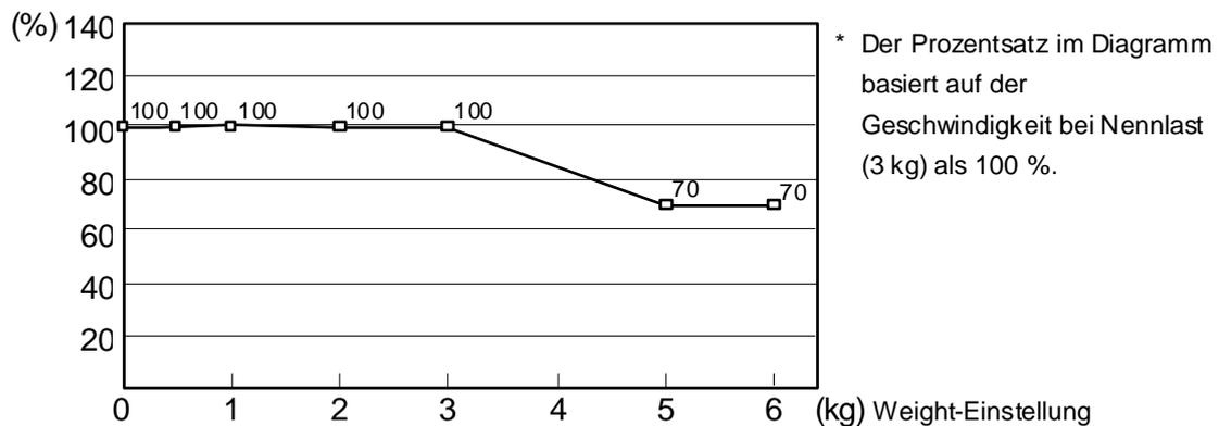
Automatische Beschleunigungs-/Verzögerungs-Einstellung durch Weight
