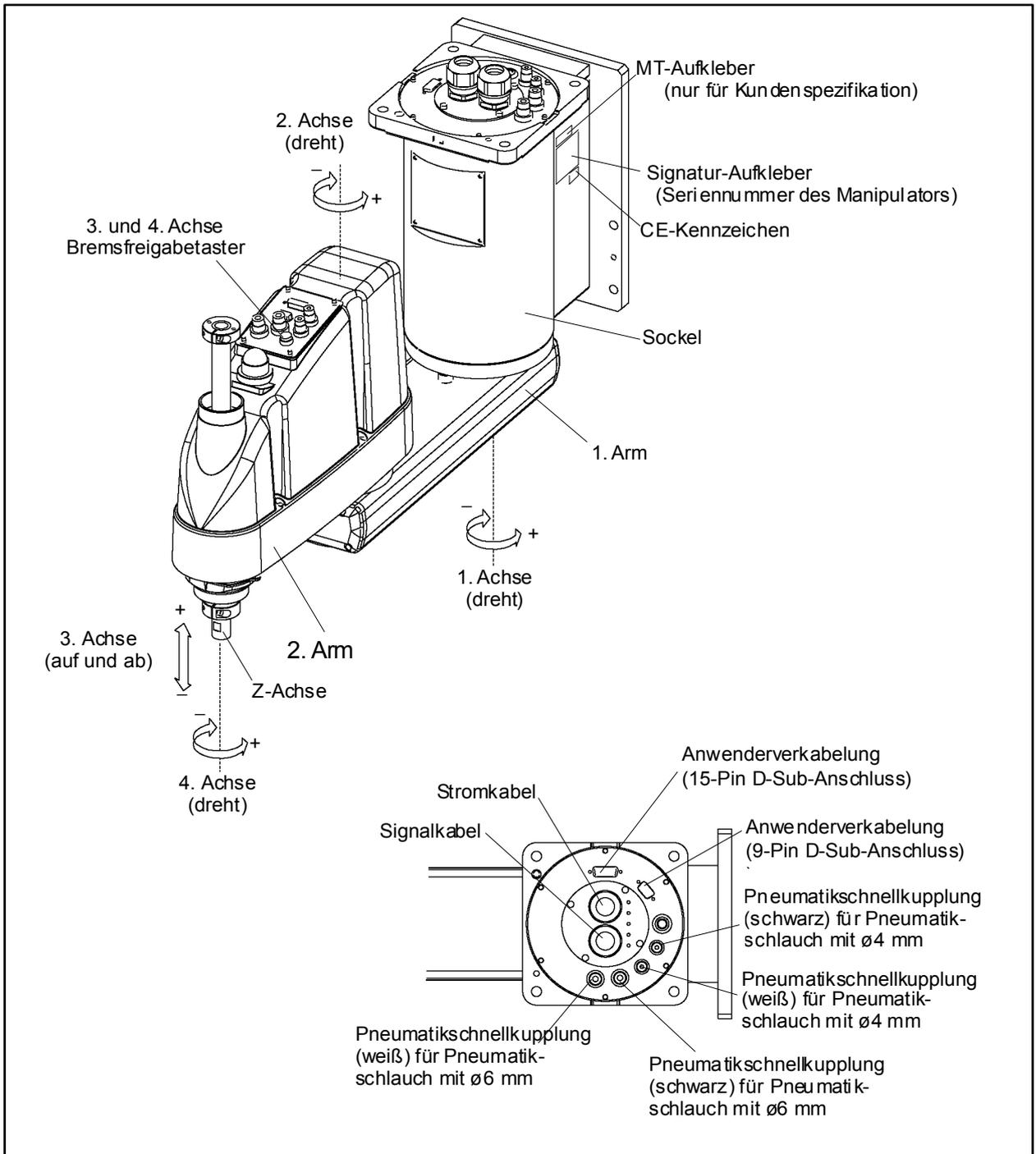
**HINWEIS** Der Bremsfreigabetaster ist mit den Bremsen der 3. und der 4. Achse verbunden. Wenn dieser Taster im Not-Aus-Modus betätigt wird, werden gleichzeitig die Bremsen beider Achsen gelöst. (G6-\*\*1\*\*: Bei diesem Modell hat die 4. Achse keine Bremse.)
