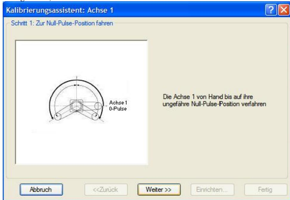
0-Pulse-Position der 1. Achse : Position an der X-Achse im Manipulator-Koordinatensystem ausgerichtet.
