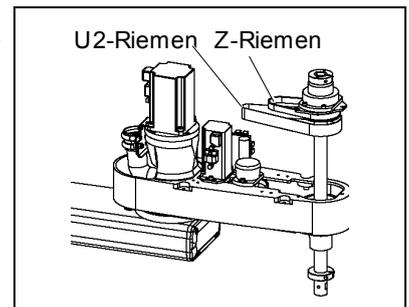
(2) Befestigen Sie die Befestigungsschrauben der Mutter der Kugelumlaufspindel auf der Unterseite des 2. Arms.
