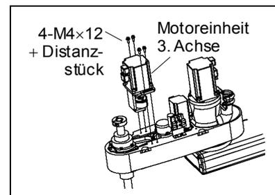
(8) Entfernen Sie den Motor der 3. Achse von der Z-Platte.
