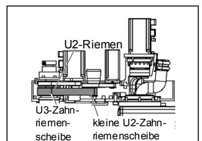
(7) Befestigen Sie die Motoreinheit der 3. Achse, die Zwischenwelle und die Motoreinheit der 4. Achse in folgender Reihenfolge locker am 2. Arm:
