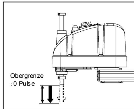
0-Pulse-Position der 4. Achse : Position, in der die flache Seite der Z-Achse der Spitze des 2. Arms gegenübersteht.
