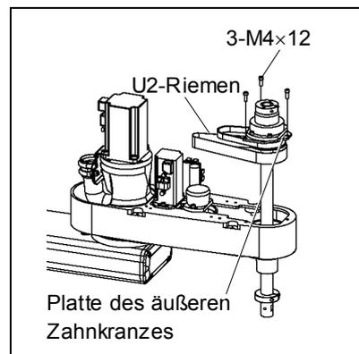
U2-Riemen (1) Legen Sie den U2-Riemen über die Z-Achse und bringen Sie die Kugelumlaufspindel am 2. Arm an.
