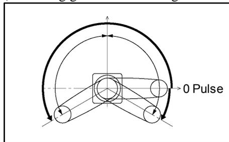
0-Pulse-Position der 2. Achse : Position, in welcher der 1. und der 2. Arm auf einer Geraden liegen.
