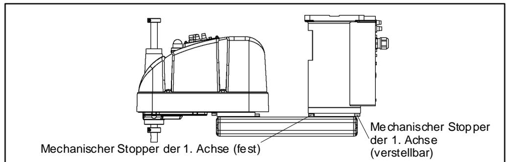
\* Die Positionen der mechanischen Stopper, die sich von denen der Tischplattenmontage unterscheiden, sind für die Wand- und die Deckenmontage aufgeführt.
