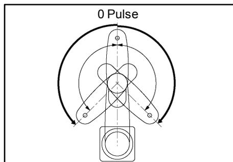
0-Pulse-Position der 3. Achse : Obere Grenzposition im Arbeitsbereich.
