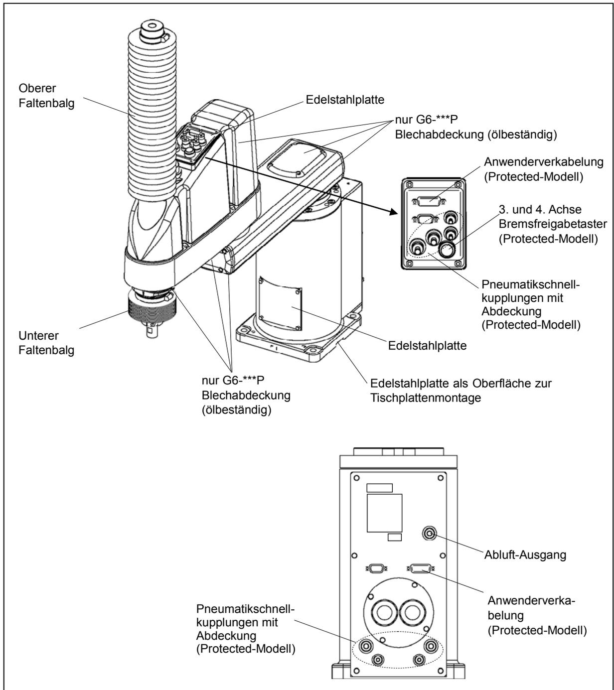
HINWEIS Bei dem Protected-Modell sind alle äußeren Schrauben aus Edelstahl.
